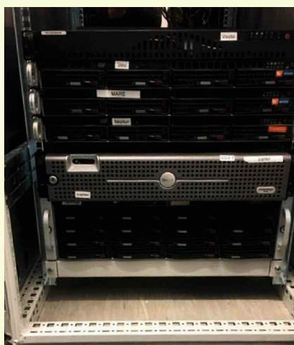
Die fünf Server im neuen Rack haben Namen, von oben nach unten: vesta, uranus, mars, neptun und jupiter. Ganz unten der Storage-Server mit insgesamt 16 Festplatten und einer Gesamtkapazität von nun 40 Tbyte; links: Ansicht von vorn, rechts: die Rückansicht offenbart das kreative Chaos.
